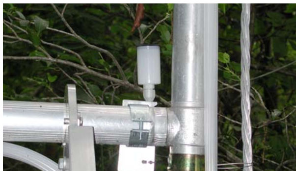
Photo 2.4-2 空気取り入れ口（フィルムケース）（富士吉田森林気象試験地）
