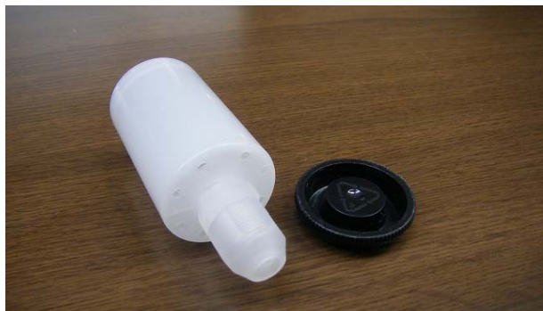
Photo 2.4-2 空気取り入れ口（フィルムケース）（富士吉田森林気象試験地）
