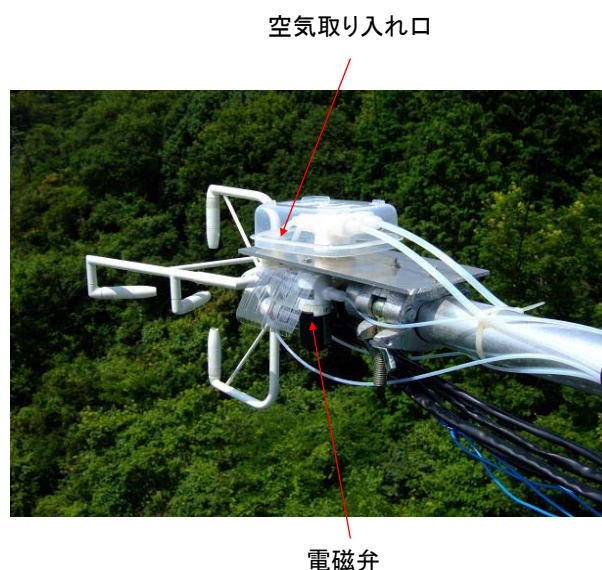
Photo 2.5-1 REA 法システムの SAT と空気の取り入れ口の例。(山城水文試験地)
