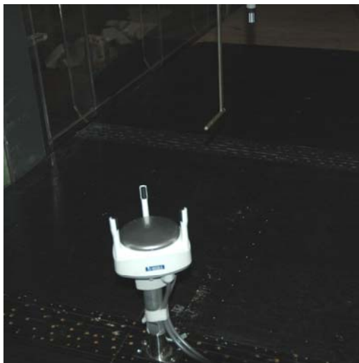
Photo 3.2-2 風洞での超音波式風速計検定の様子。
