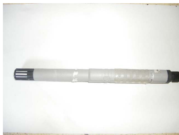
Photo 3.3-3 Vaisala 製 HMP45D（白金温度計）。
