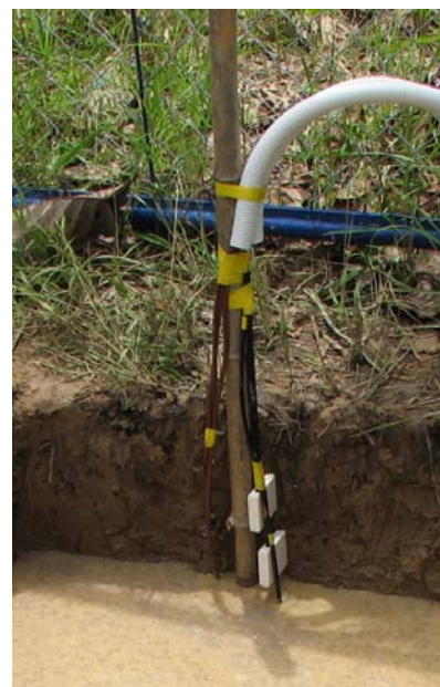
Photo 3.5-4 熱電対温度センサ (棒の左側) と土壌水分計 (棒の右側) の埋設断面。(カンボジア国クラティエ州の季節林)
