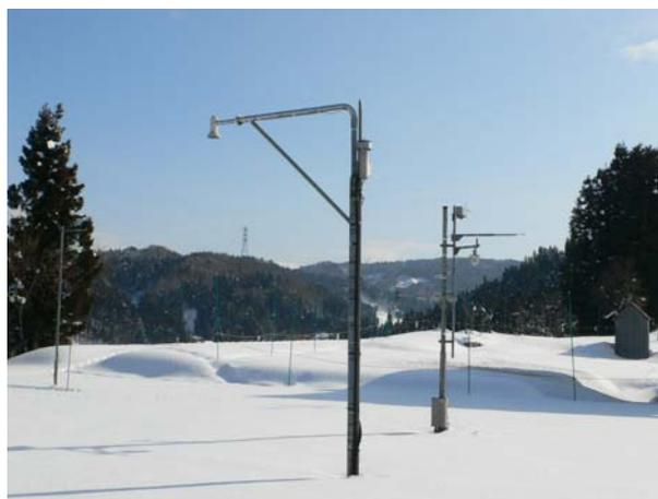
Photo 3.7-2 超音波積雪深計の測定風景。(十日町試験地)
