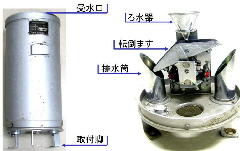
Photo 3.7-1 転倒マスの外観と構造。
