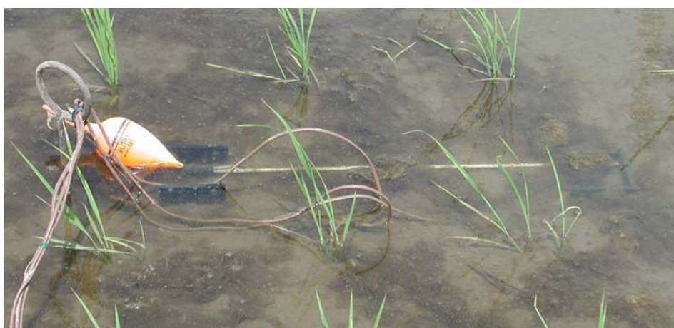
Photo 3.8-1 浮子を用いた田面水温の測定例。（真瀬水田フラックスサイト）
