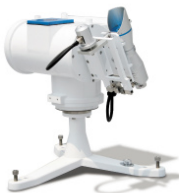
Photo 3.1-2 直達日射計（MS-56）。太陽追尾装置（STR-21）にとりつけたもの。（写真：英弘精機㈱提供）
