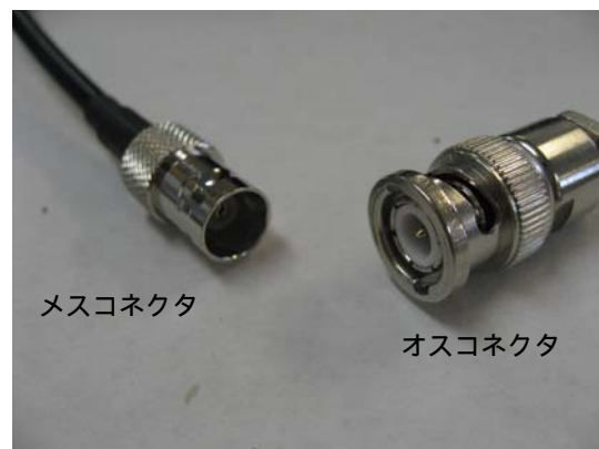
Photo 3.1-8 LI-190 のケーブル延長の方法。左: BNC コネクタ部分の防水のため、自己融着テープを巻く。右: メスコネクタ (延長ケーブル側) とオスコネクタ (センサ側)。
