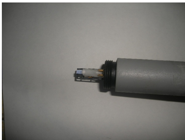
Photo3.4-1 HMP45D の高分子薄膜フィルム湿度センサと白金抵抗温度センサ (Pt100)。
