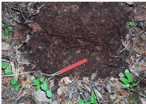
Photo 3.5-7 熱流板埋設の様子。(川越森林気象試験地)
