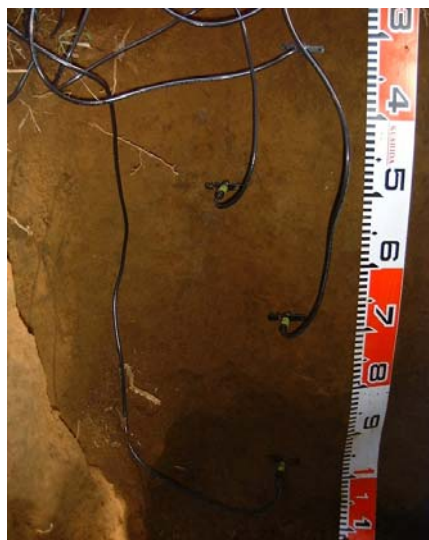
Photo 3.6-3 土壌水分計 (EC-5) 設置のために作成した土壌断面。(筑波大学陸域環境研究センター, 写真: 森林総合研究所飯田真一氏提供)
