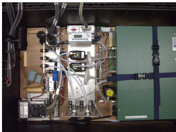
Photo 2.3-1 Fig. 2.3-1 に示したクローズドパス型 CO 2 分析計による空気サンプリングシステム。
