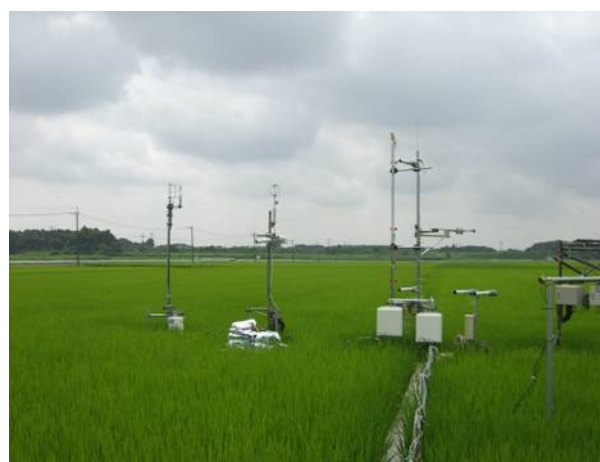
Photo 1.2-1 ポール状のタワー。 （真瀬水田フラックスサイト）
