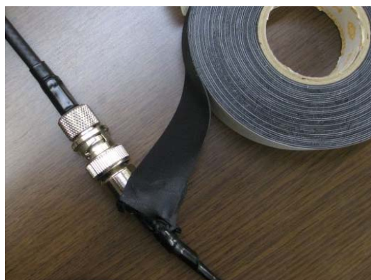
Photo 3.1-8 LI-190 のケーブル延長の方法。左: BNC コネクタ部分の防水のため、自己融着テープを巻く。右: メスコネクタ (延長ケーブル側) とオスコネクタ (センサ側)。
