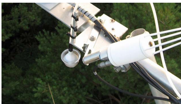
Photo 2.4-1 空気取り入れ口（ロートおよび茶こし）（富士吉田森林気象試験地）
