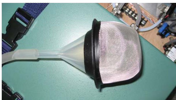
Photo 2.4-1 空気取り入れ口（ロートおよび茶こし）（富士吉田森林気象試験地）
