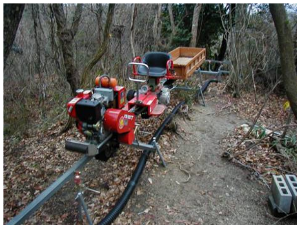
Photo 1.2-4 資材運搬に用いるモノレール。
