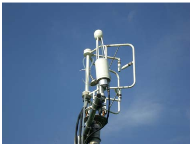
Photo 2.2-1 オープンパス (LI-7500) の設置状況 (真瀬水田フラックスサイト)。写真奥は、SAT (ソニック (旧カイジョーソニック), DA-600)。観測サイトの主風向は、東～南。SAT の開口部は南方向に向けてある。そのため、東から風が吹く場合 (紙面裏から表に向かう方向) でも、LI-7500 が風速測定に及ぼす影響は小さい。北風 (DA-600 の後面方向から吹く風) や西風 (LI-7500 の設置方向から吹く風) の頻度は少ない。
