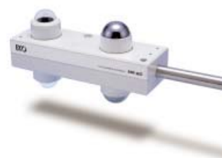
Photo 3.1-6 4成分放射計。左：CNR 4。（写真：Kipp & Zonen B. V.提供），右：MR-60。（写真：英弘精機(株)提供）。
