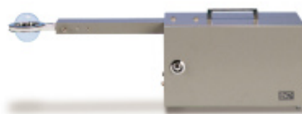
Photo 3.1-5 放射収支計。左：NR Lite2。（写真：Kipp & Zonen B. V.提供）、右：MF-11。（写真：英弘精機(株)提供）。
