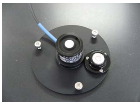
Photo 3.1-7 光量子センサ。左：LI-190 (LI-COR)，右：ML020P (英弘精機)。
