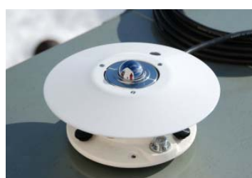
Photo 3.1-4 赤外放射計。左：CGR 4。（写真：Kipp &amp; Zonen B. V.提供），右：EPPLEY 製 PIR。
