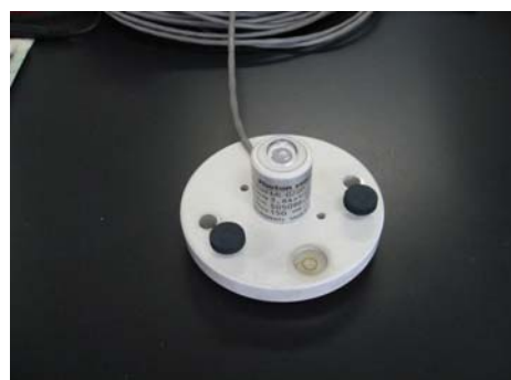
Photo 3.1-7 光量子センサ。左：LI-190 (LI-COR)，右：ML020P (英弘精機)。
